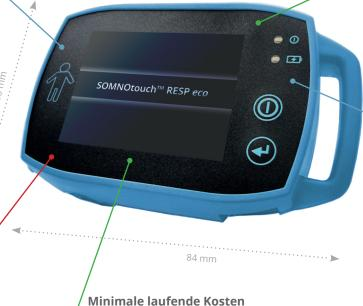
Wiederverwendbare Sensoren, günstige Einwegartikel zur Flow-Messung, eingebauter Li-Ion-Akku
