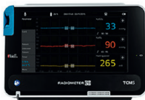
TCM5 FLEX transkutaner CO 2 Monitor – Einbindung via Optokoppler (optional)
